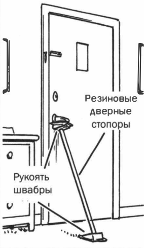
ПД 4: блокирование дверной ручки
